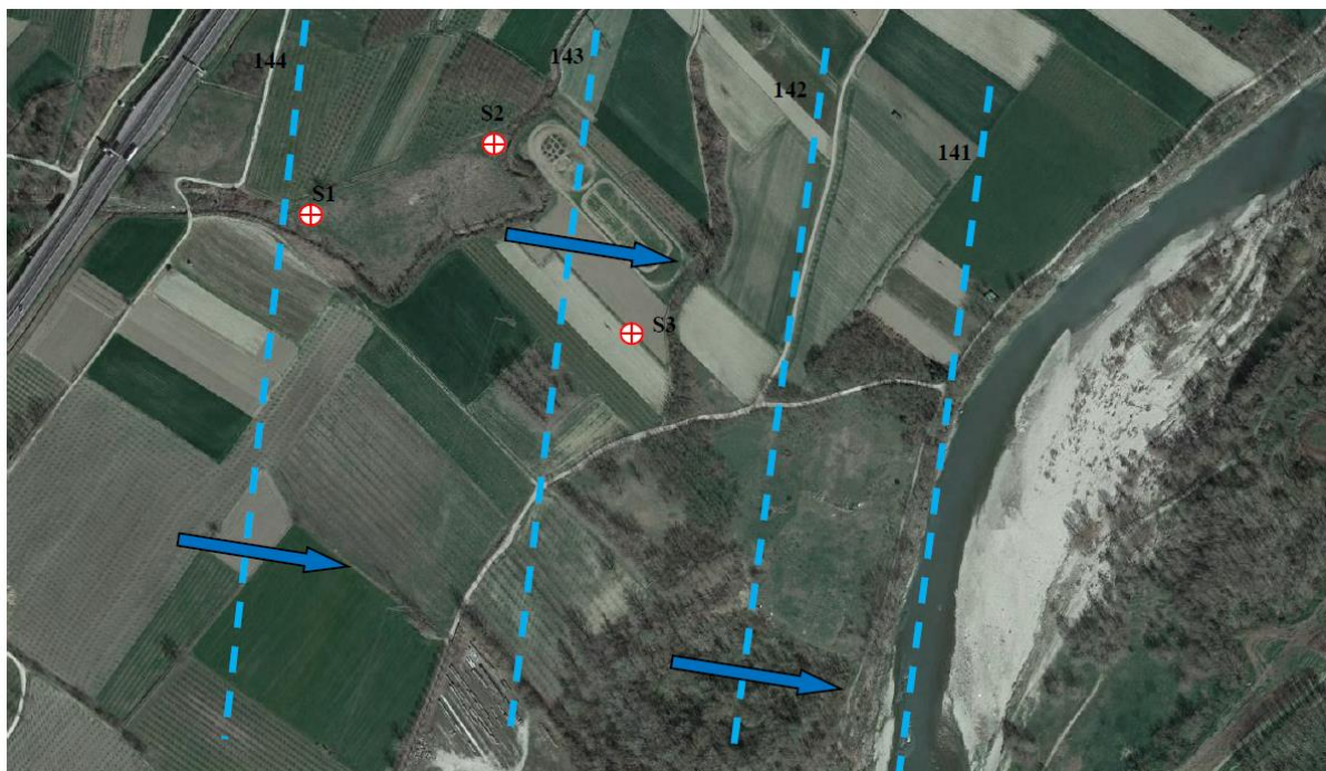
Figura 7-8 – Panneggio piezometrico nell’area di cava
